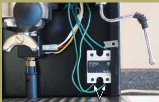
Fig. 4 SSR wiring detail.
